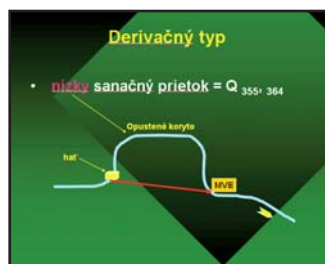
Obr. 1: Hlavné vplyvy derivačnej MVE
