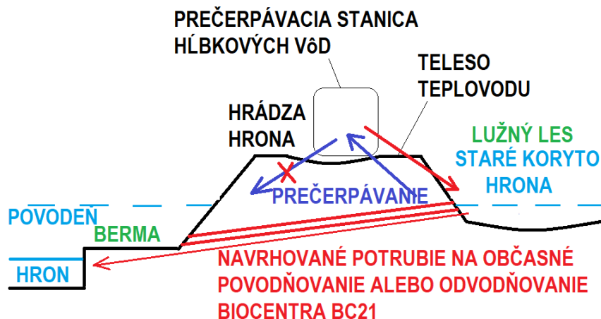
Obr.10: Schéma zavodenia BC Bariny: pri povodniach navrhovaným potrubím, mimo nich presme-
